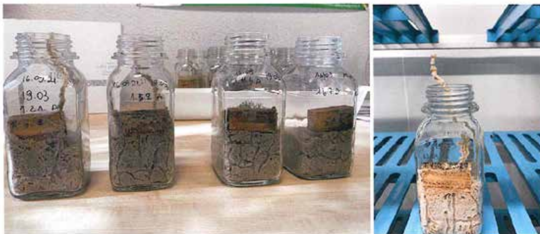
Fig 4 Aspect des dispositifs d'essai à l'issue de l'exposition aux termites (à g. aubier de Pin Lariciu, à d. aubier de pin sylvestre, témoin de virulence)
