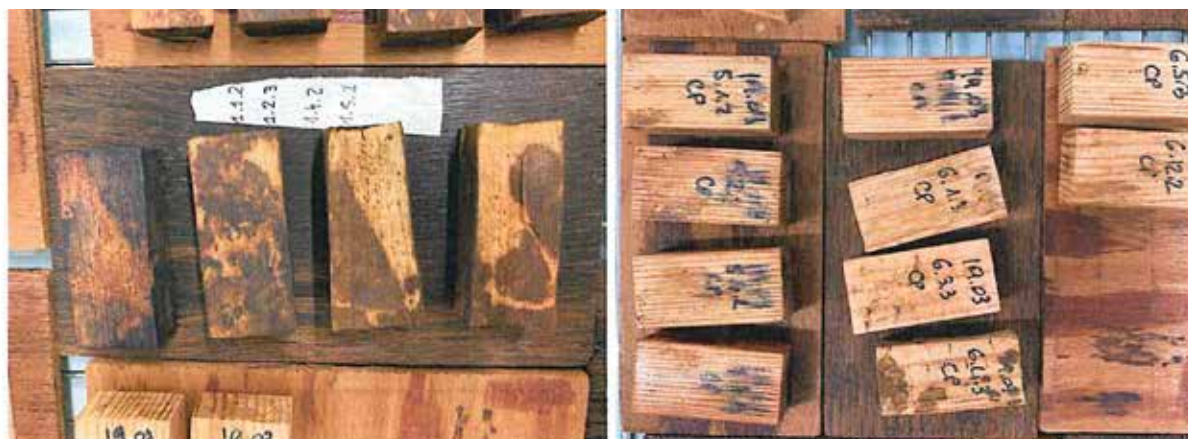
Fig 6 Aspect des éprouvettes d'essai à la fin de l'exposition fongique, après séchage à 103°
