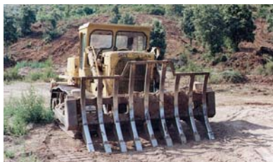
Bulldozer équipé d'une lame Fléco
