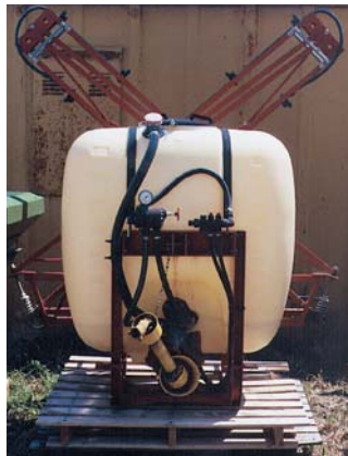
Cuve et rampe de traitement
